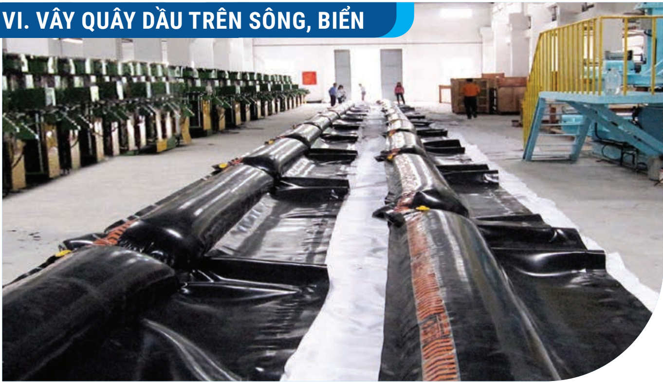
Sản phẩm Vây quây dầu tràn đang được nghiệm thu tại Công ty TNHH MTV Cao su 75
