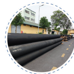
Bọc Composite cách nhiệt đường ống dẫn dầu dưới biển
